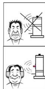
**Lärmpegel:** Der Lärmpegel eines nicht abgeschirmten, auf einem Blech montierten Klopfers kann 85dB(A) übersteigen. Der vom Gerät ausgehende Schall kann durch Umkleidungen abgedämmt werden.
